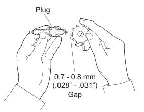
Fig. 31 Gapping the Spark Plug
